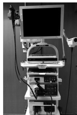
รูปที่ 1. จอมอนิเตอร์และ ultrasound processor
